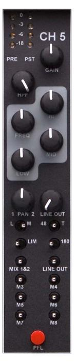
CHANNEL METERS, PRE-FADER and POST-FADER **PRE-AMPLIFIER GAIN CONTROL HIGH PASS FILTER HIGH FREQUENCY E.Q.** MID FREQUENCY ADJUST (PARAMETRIC) MID FREQUENCY E.Q. LOW FREQUENCY E.Q. PAN POT, CHANNEL LINE OUT LEVEL ADJUST LINE/MIC INPUT SELECTION, MICROPHONE POWER LIMITER, AUDIO PHASE REVERSAL MIX 1 & 2 (PAN POT) SELECT, LINE OUT SELECT MIX BUSS 3 SELECT, MIX BUSS 4 SELECT MIX BUSS 5 SELECT, MIX BUSS 6 SELECT MIX BUSS 7 SELECT, MIX BUSS 8 SELECT PRE-FADE LISTEN SWITCH
